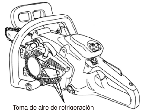
Toma de aire de refrigeración
