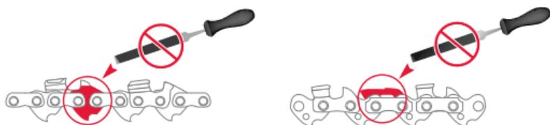
4. Limez les gouges de la chaîne de scie de l'intérieur vers l'extérieur (si la chaîne est carrée, limez la gouge de l'extérieur vers l'intérieur).
