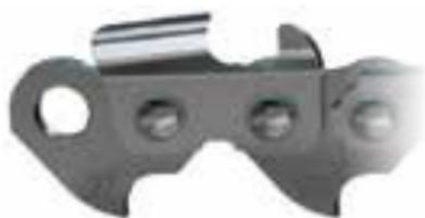
Spécialement adaptée pour le délignage – réalise des coupes parallèles au grain du bois. 27R, RX a une application spéciale pour le délignage qui permet d'obtenir des planches et panneaux à partir de bois de grandes dimensions. 27RX est une séquence par sauts exceptionnelle qui offre une meilleure chute des copeaux lors des coupes très larges. Pour une utilisation sur les scieries à chaîne. Utilisation pour coupe manuelle non recommandée.
