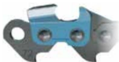
Chaîne idéale pour les bûcherons professionnels qui utilisent des scies à pas 3/8 po. Les gouges Full Chisel à faibles vibrations offrent une performance maximale. Les limiteurs de profondeur déportés empêchent les gouges d'entrer dans la paroi latérale de la coupe, ce qui offre une coupe plus régulière.
