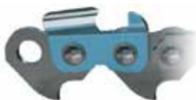
Chaîne haute performance et très résistante pour les professionnels qui utilisent de grandes tronçonneuses. Idéale pour ceux qui préfèrent la durabilité et l'entretien facile des gouges Micro Chisel®. Les gouges Micro Chisel ont des angles d'attaque à faible rayon, garantissant une excellente performance et un entretien facile.
