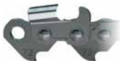
Spécialement adaptée pour le délignage – réalise des coupes parallèles au grain du bois. 72, 73, 75 RD a une application spéciale pour le délignage qui permet d'obtenir des planches et panneaux à partir de bois de grandes dimensions. Pour une utilisation sur les scieries à chaîne. Utilisation pour coupe manuelle non recommandée.
