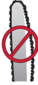
Les problèmes de chaîne ou de chaîne-guide sont causés le plus souvent par une tension de chaîne incorrecte et non par un autre facteur.
