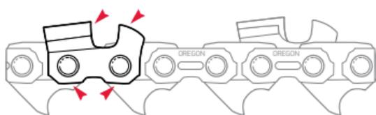
3. Placez l'attache préréglée sur la surface extérieure plate de l'enclume du dérive-chaîne. Assurez-vous que les rivets sont orientés vers le haut.
